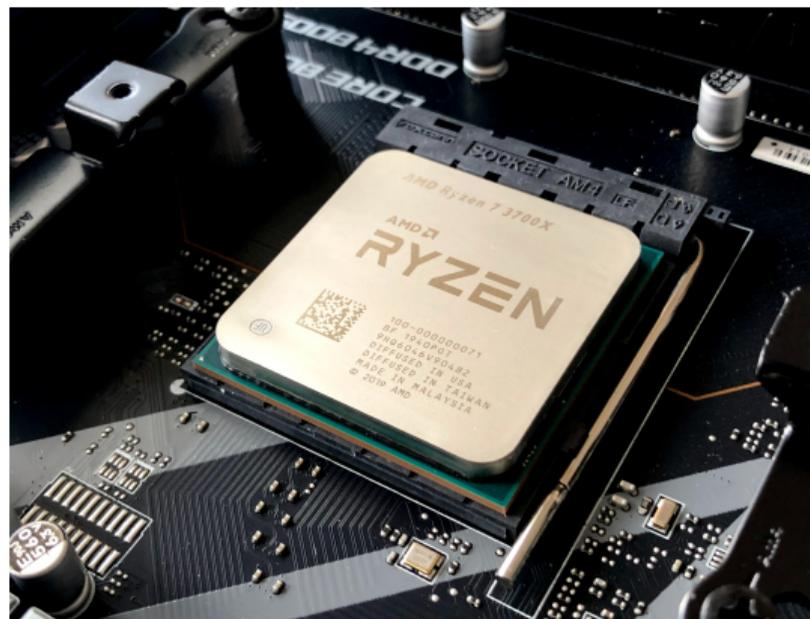
Abbildung: AMD Ryzen 7 CPU in den Sockel eingebaut. Foto von [Olivier Collet](#) auf [Unsplash](#).
